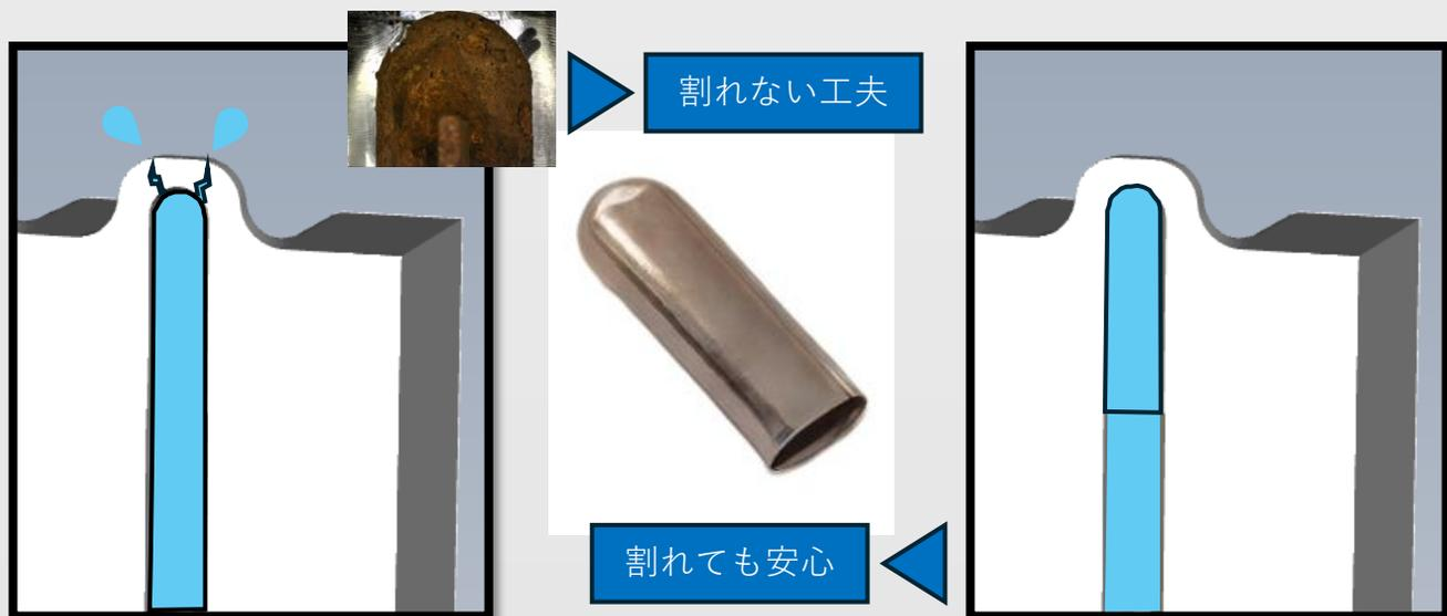
金型では冷却穴内部が腐食し、それを起点に形状面までクラックが発生する可能性がある
